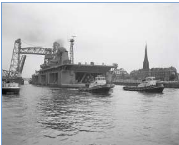
La Choctaw I de Santa Fe, première barge de pose semi-submersible
