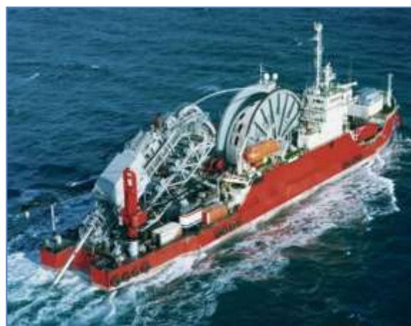
La barge Apache était capable d'installer des pipelines jusqu'à 16" de diamètre dans 600 m de profondeur d'eau lors de son lancement en 1978
