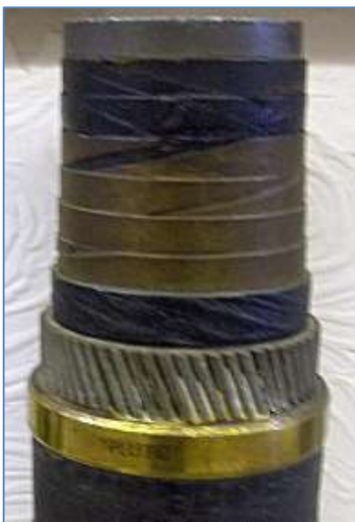
Le pipeline HAIS avec ses couches successivement enroulées
