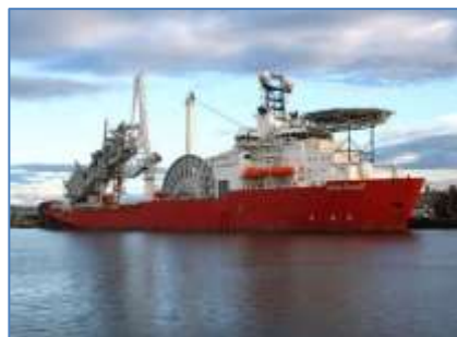
Seven Oceans - Navire de pose de conduites rigides et flexibles
