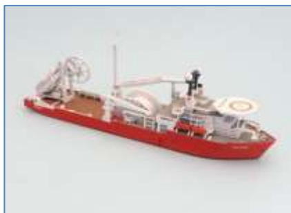
Seven Oceans - Navire de pose de conduites rigides et flexibles
