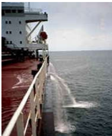
Déballastage - Photo US Coast Guards
