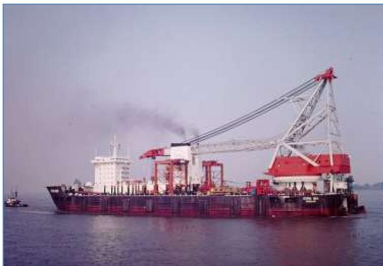
Côté propulsion, 2 hélices à pas variable, des générateurs électriques d'une puissance de 8 000 cv permettent d'avancer à une vitesse moyenne d'environ 7 nœuds. Un propulseur d'étrave de 750 cv permet également de faciliter certaines manœuvres délicates.
