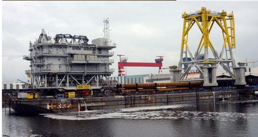
← Fin des opérations de chargement de la sous-station électrique, le topside de 1 500 tonnes et de 31m x 18 m x 16m de hauteur a trouvé sa place (crédit photo STX France, Bernard Biger)
