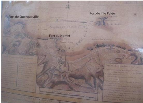
Négligeant de sonder convenablement les fonds, le département de la Guerre propose d'abord le projet de fermer la baie par une digue de 1800mètres de long, allant de la pointe du Homet à l'île Pelée, avec deux passes, formées de caissons remplis de maçonnerie. Un plan peu ambitieux, bâti dans l'improvisation, et qui rétrécit considérablement la rade.
