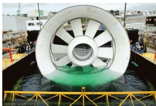
La turbine de l'hydrolienne (© DCNS)
