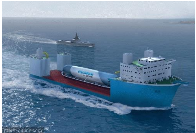
Transport par navire semi-submersible (© : DCNS)
