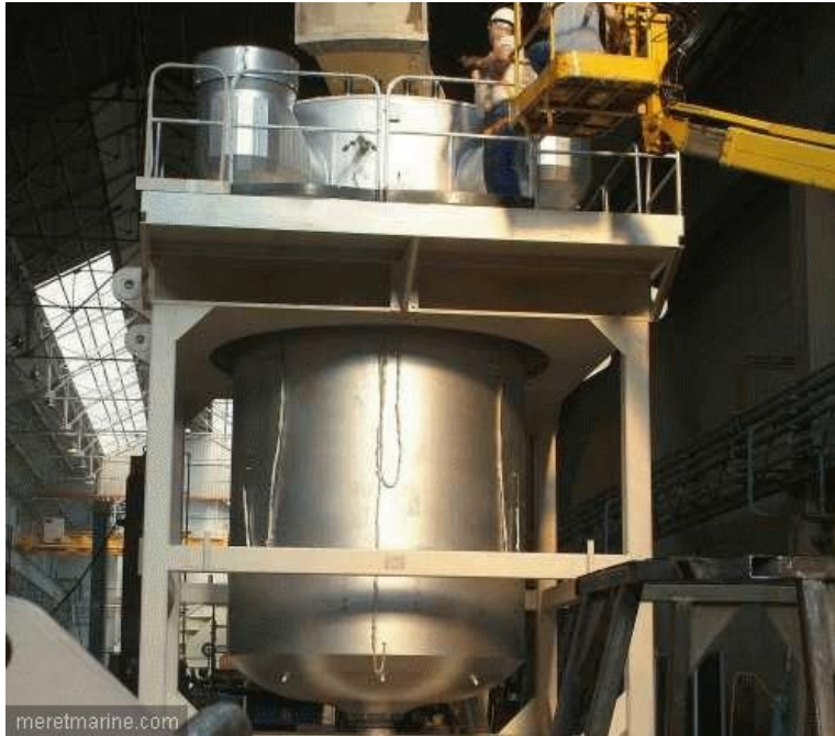
Chaufferie de sous-marin nucléaire (© : DCNS)
