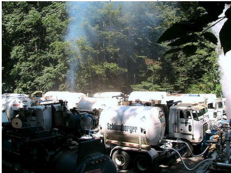
← Camions citernes pour la fracturation hydraulique
