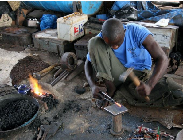
Forgeron fabriquant des clous à Mopti
