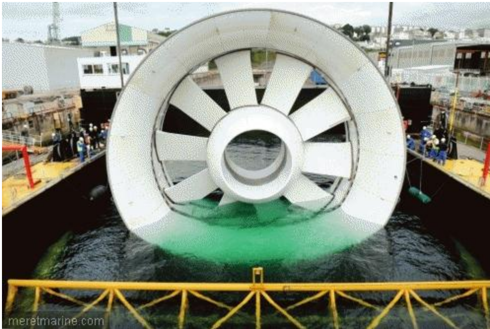
La turbine de l'hydrolienne sur la barge, ici à Brest crédits : DCNS
