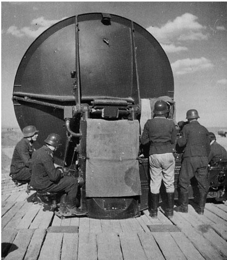
Figure 4: un des radars de guidage pour canons anti-aériens Würzburg A installés sur la côte entre la Hollande et le Danemark. Ces matériels ont été produits par la firme Telefunken dès 1940
